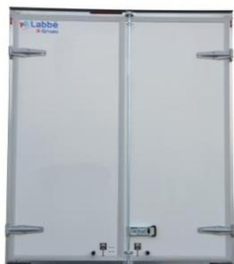
Fermeture par 2 portes arrière battantes version simple
