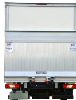
Fermeture par un auvent relevable arrière et hayon élévateur
